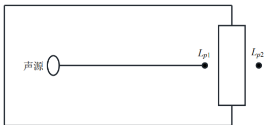
图 4-2 室内声源等效为室外声源图例
